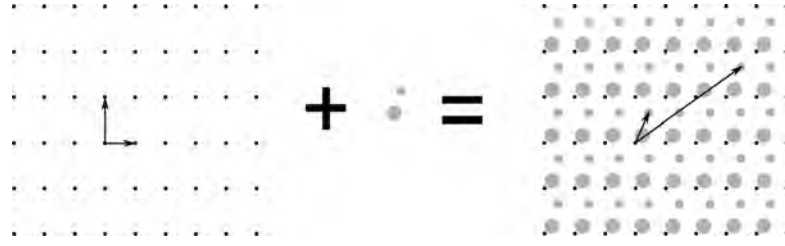
Figure 1. Un cristal está compuesto de una retícula infinita definida por vectores de traslación y una base atómica.
