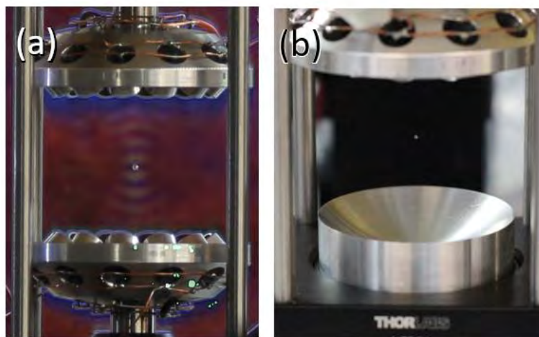
Figura 4. (a) Levitador acústico T-T basado en dos arreglos de 18 transductores levitando una esfera de acero de 2 mm de diámetro. El diseño es una versión miniaturizada del levitador TinyLev. En la fotografía se observa el gradiente de presión asociado a la onda estacionaria a través de deflectometría schlieren. (b) Levitador acústico T-R basado en un arreglo de 8 transductores y un reflector cóncavo levitando una gota de agua.
